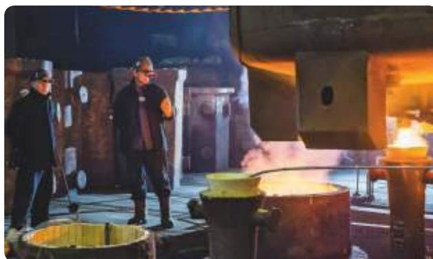
Разливка стали сифонным способом
