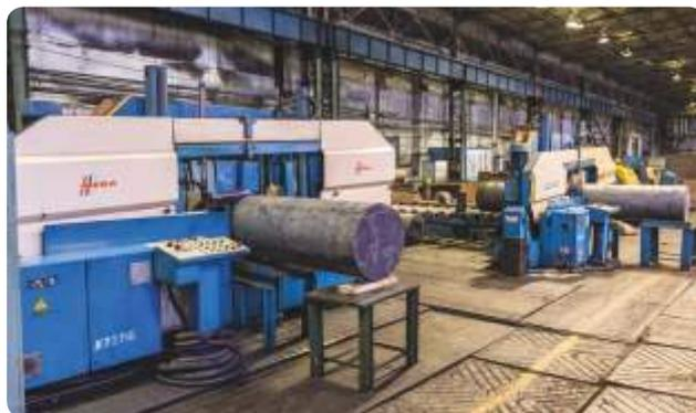
Резка поковок на ленточнопильных станках
